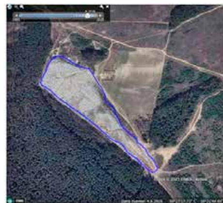
Стан сміттєзвалища на 2016 Географія ТПВ – м. Вишгород, с. Нові Петрівці, с. Старі Петрівці, с. Лютіж, Лівий берег Вишгородського району, м. Київ (з 2010), м. Ірпінь (з 2012), м. Буча (з 2015) Активна зона захоронення – 68,5 тис. кв. метрів
